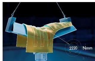
*Der Lower Costal Bending (LCB)-Test ahmt die Biegebewegung eines Oberkörpers nach. Im Dienst führen solche Bewegungen zu Energieverlusten und schnellerer Erschöpfung des Trägers.*
