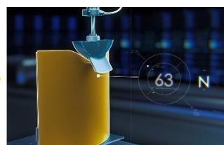
*Der Edge Pressure (EP)-Test bildet die Form des Arms und die Krümmung einer ballistischen Weste nach und quantifiziert das Unbehagen, das an lokalen Druckpunkten entsteht.*
