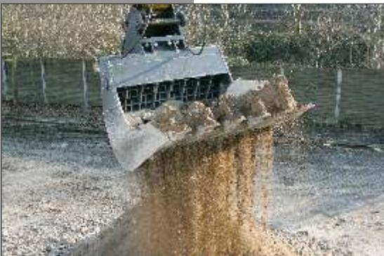
Die **"DASIE"-Siebschaufel** ist ideal einsetzbar im Gala-, Straßen- und Kanalbau, sowie im Abbruch und in Steinbrüchen. Aussieben von Bauschutt, Erdmassen und vor allem die wirtschaftliche Rückgewinnung von verwertbarem, aufbereitungsfähigem Gesteinmaterial, bringen Ihnen eine erhebliche Ertragsverbesserung.
