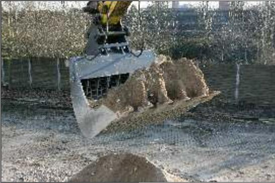
Mit der **"DASIE"-Siebschaufel** können Sie alle auf der Baustelle anfallenden Materialien wie Bauschutt, Baumischabfälle, Erdmassen, Schlacken oder Müllverbrennungssasche sinnvoll trennen und wiederverwenden. Sie gewinnen Lagervolumen, sparen so Transport- und Deponiekosten.
