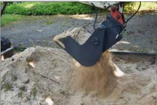
Die **"DASIE"-Siebschaufel** wird eingesetzt im Garten- und Landschaftsbau zum Auskoffern von Pflasterstraßen mit gleichzeitiger Rückgewinnung von Pflastersteinen oder zum Reinigen und Belüften von Spielsand, bzw. Mutterboden.
