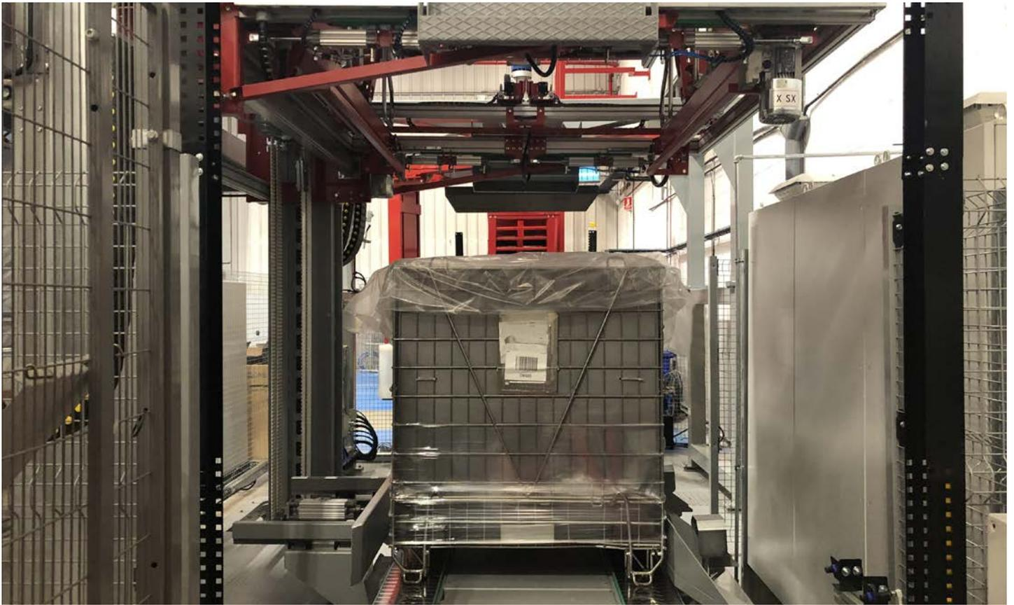
Die Sackaufsetzmaschine Bocedi MS/L ist die vollautomatische Lösung zum Einsetzen maßgefertigter Säcke in industrielle Behälter wie: Octabins, Goodpacks, Holzkisten, großformatige Kartons...
