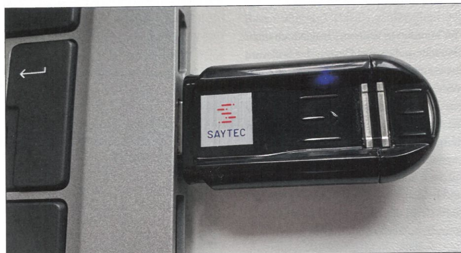
Bild 2: Ein biometrisch geschützter USB-Stick mit der sayTRUST Software an Bord ist der Zugangsschlüssel zu entfernten Ressourcen.
