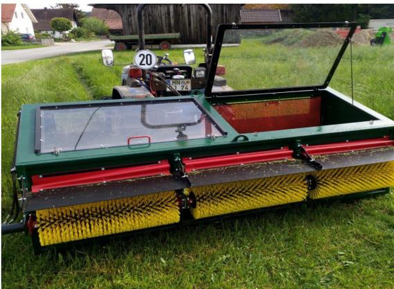
Der **NeiG Wiesensamensammler Wiesefix WSH 180** ist mit einer Arbeitsbreite von 1,80 Metern eines der mittleren Geräte unserer Anbaugeräte.
