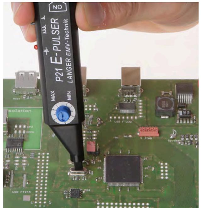
Abbildung 4 Einkopplung von elektrischem Feld in einen Quarzoszillator
