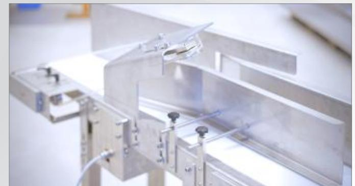
Edelstahlförderband für Verpackungsmaschine | Stainless steel conveyor belt for packaging machine
