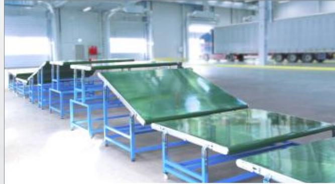
H100 Förderstrecke mit 2,5 m Breite | H100 conveyor line with 2.5 m width
