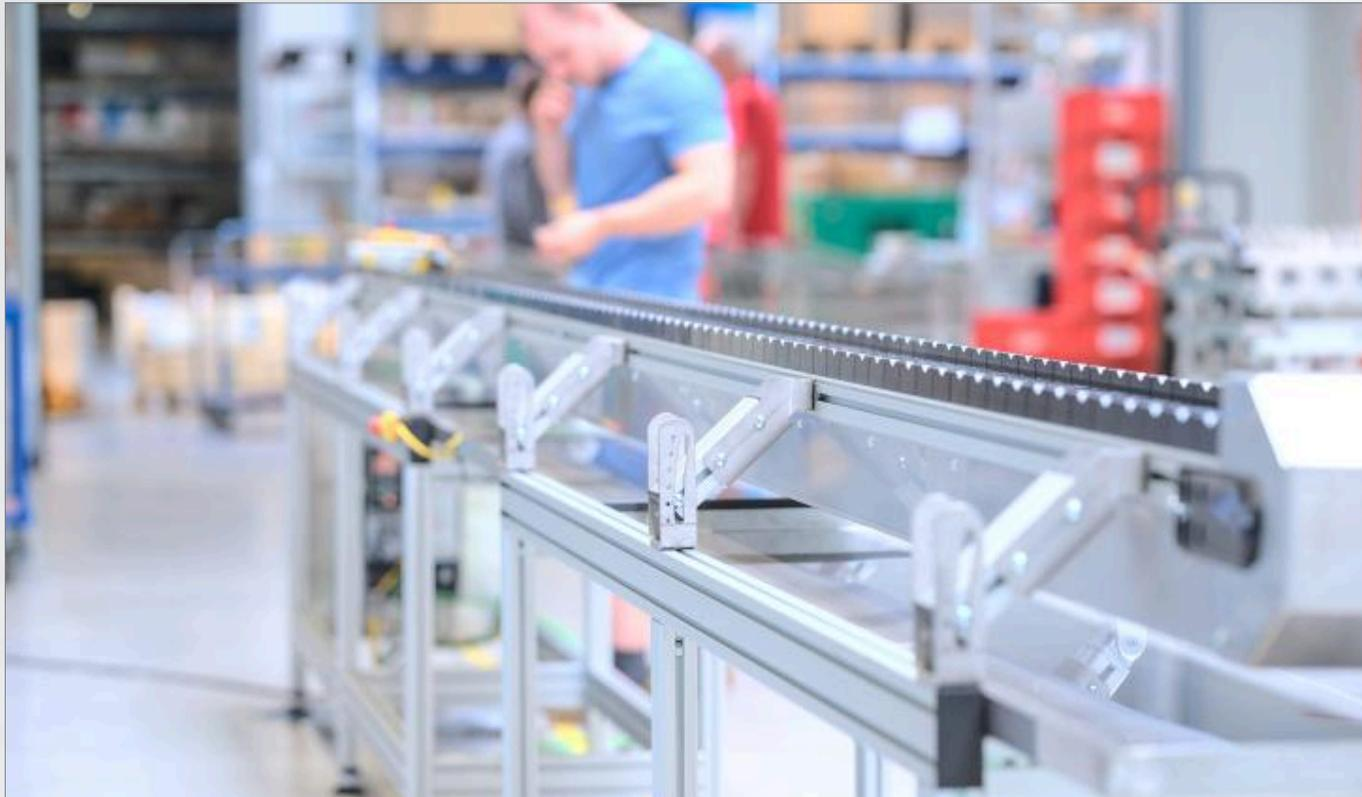
Taktband mit Prismenaufnahmen | Clocked belt with prismatic receptacles
