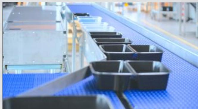
Förderbänder mit Kunststoffgliederort und Seitenführung | Conveyor belts with plastic link belt and side guide
