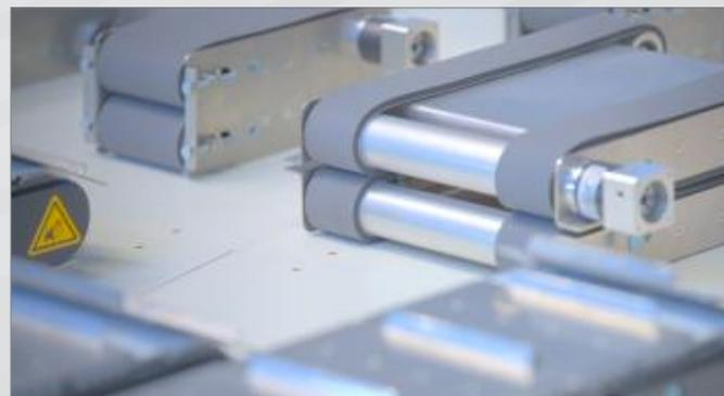
Förderbänder mit Klemmfunktion | Conveyor belts with damping function
