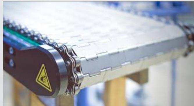
Scharnierplattenförderband | Hinged plate conveyor belt
