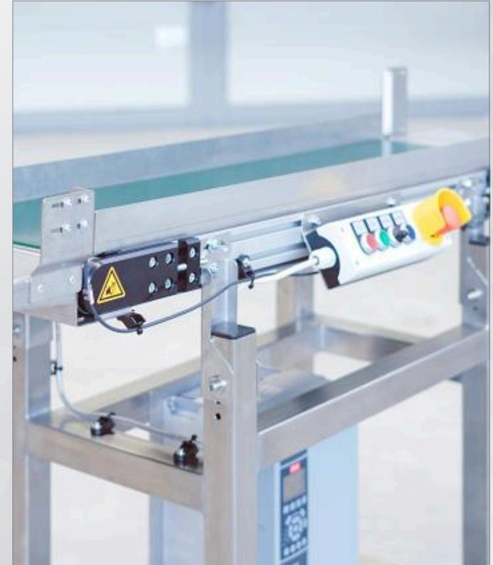
Förderband als Abkühlstrecke mit Frequenzrichter | Conveyor belt as cooling line with frequency converter
