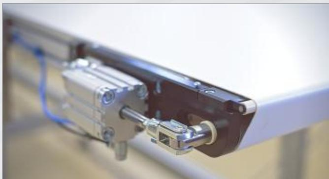
Messerkante mit aktiver Gursteuerung | Knife edge with active belt control
