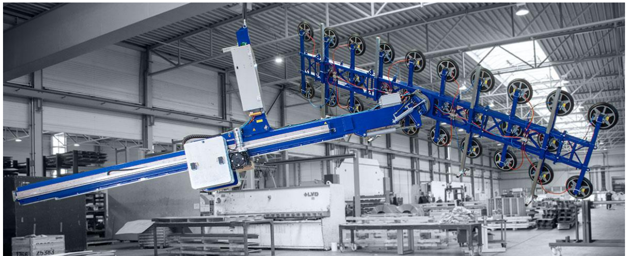
OKTOPUS® GLASS-Jack GL-M 3200 mit Gegengewichtsanlage (GGA) im Funktionstest der Drehbewegung (Quelle: Wirth GmbH)
