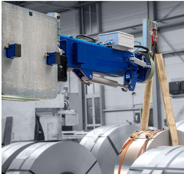
OKTOPUS® GLASS-Jack GL-M 3200 mit Gegengewichtsanlage (GGA) im Funktionstest der Lastaufnahme über einen Kranhaken (Quelle: Wirth GmbH)
