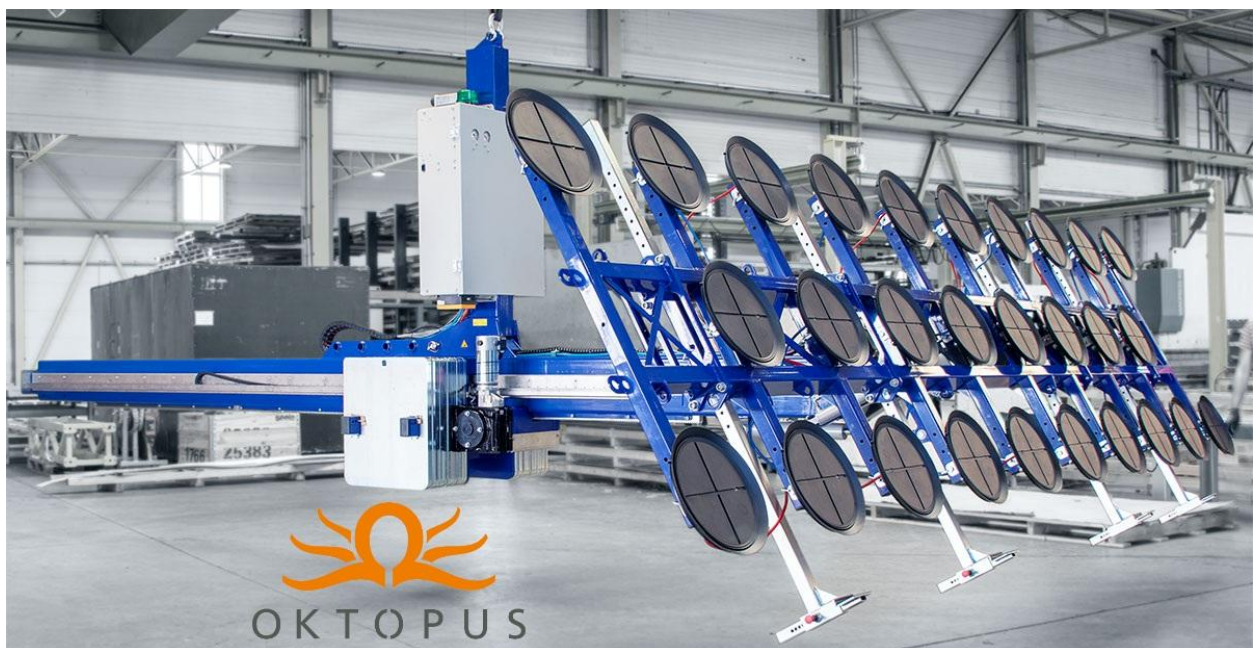
OKTOPUS® GLASS-Jack GL-M 3200 mit Gegengewichtsanlage (GGA) im Funktionstest (Quelle: Wirth GmbH)
