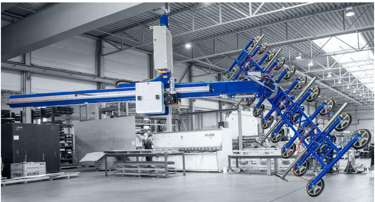
OKTOPUS® GLASS-Jack GL-M 3200 mit Gegengewichtsanlage (GGA) im Funktionstest der Schwenkbewegung (Quelle: Wirth GmbH)
