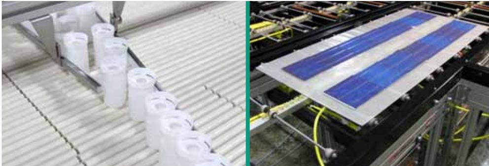
SLIP-TORQUE ERLAUBT EIN SANFTES UND PRÄZISES FÖRDERN FAST ALLER PRODUKTARTEN, ANGEFANGEN VON KLEINEN WACKELIGEN KEGELFÖRMIGEN PRODUKTEN (LINKS) BIS HIN ZU GROSSEN PANELS FÜR SOLARANLAGEN (RECHTS).
