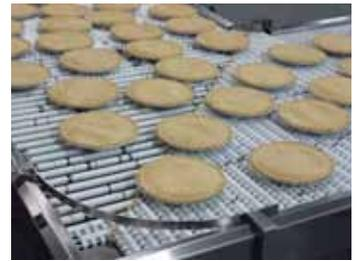
VON DER GEFRIERMASCHINE WERDEN DIE PRODUKTE IN EINE PUFFERZONE VOR DER FOLIENVERPACKUNGSMASCHINE GEFÖRDERT
