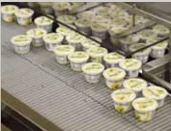
MASSEHAFTHE PRODUKTAUFSTAUUNG IN EINER REIHE BEI GERINGEM GEGENDRUCK DER FÖRDERROLLEN AUF EINEM RAHMEN AUS EDELSTAHL
