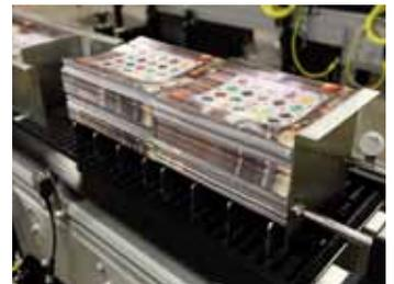
GESTAPELTE DRUCKBÖGEN WERDEN BEI EINEM INDUSTRIEROBOTER BEREITGESTELLT
