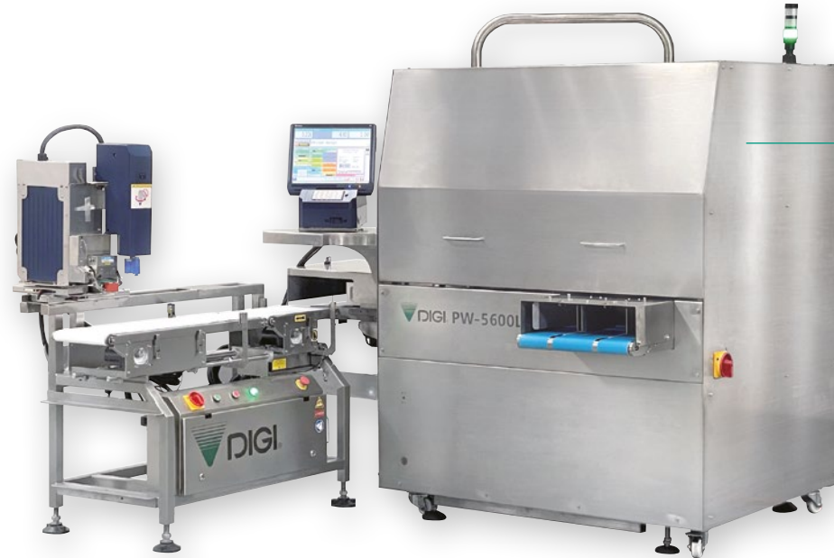
PW-5600LL mit LI-5600C (LxBxH) 2564 mm x 3165 mm x 1819 mm
