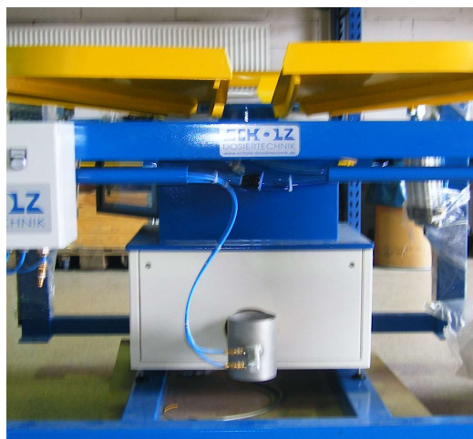
FLEX-Dosiergerät als Austragdosierer Verschlussklappe
