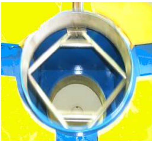
Geschlossenes Gehäuse Pneumatische Verschlussvorrichtung Manuelle BIG-BAG-Fixierung
