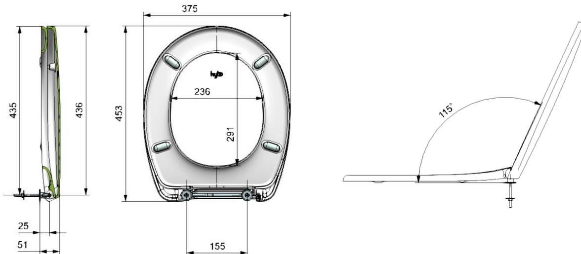
Maximaler Öffnungswinkel = 115° / maximum opening angle = 115°
