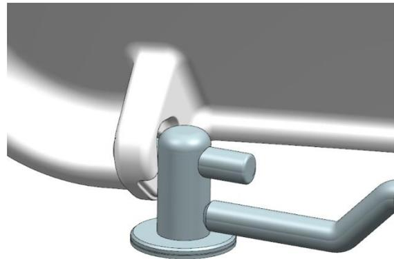
Bei ca. 60° Öffnungswinkel links auffädeln / at approx. 60° slide onto left pin
