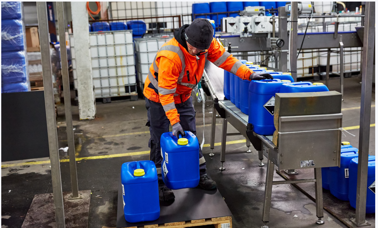
Chemie Wocklum: Mitarbeiter palettiert ca. 40 kg schwere Kanister manuell – vor der Installation der Roboteranlage zum Palettieren
