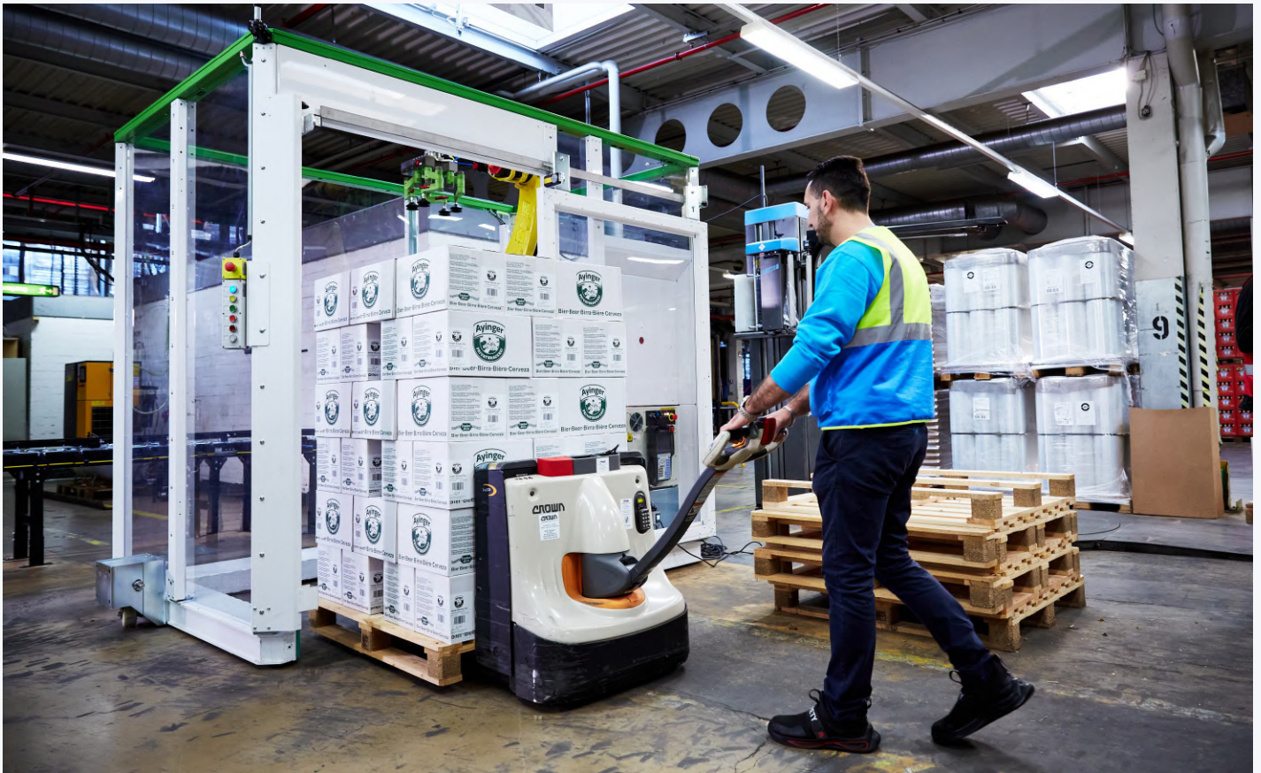
SIRL Interaktive Logistik: Kartons mit Bier werden mithilfe der mobilen coboworx „Basic Move“ Palettierlösung palettiert
