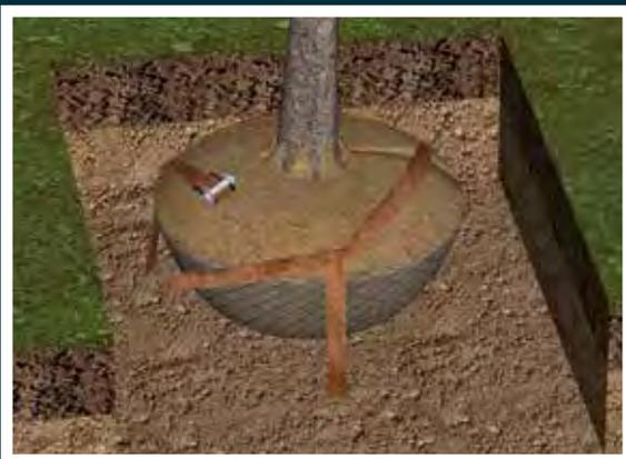
Die Ballenschutzscheibe auf den Ballen legen und den Ratschengurt durch die Ankerschlaufen führen. Den Gurt so weit wie möglich durch die Ratsche fädeln.
