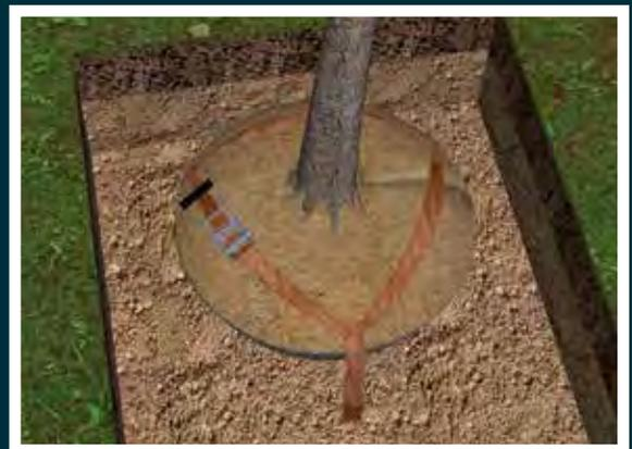
Griff am Hebels ziehen und auseinander gefahrene Ösen über das Ratschenunterteil führen und einrasten lassen.
