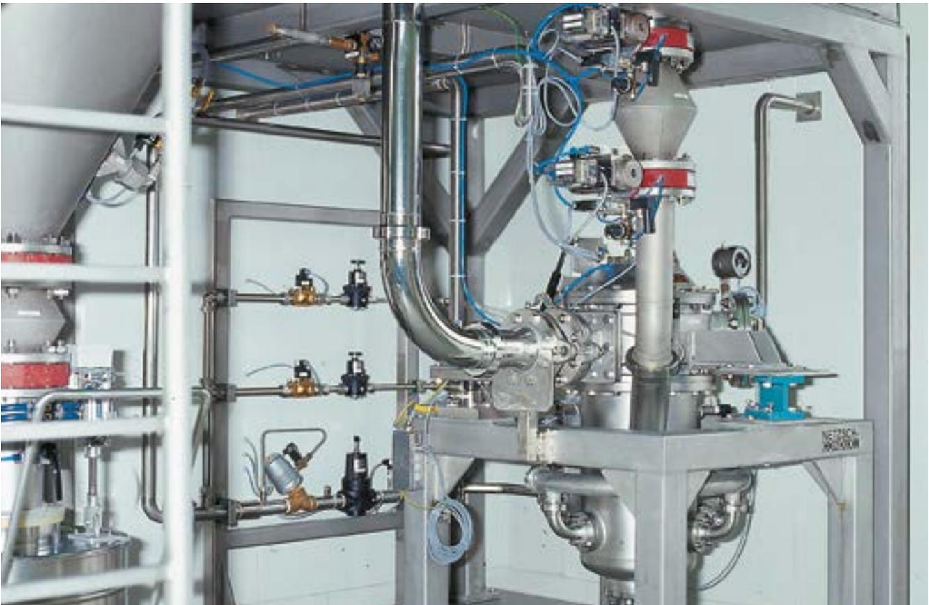
Installation mit Fließbettstrahlmühle CGS 32 in Pharma-Ausführung
